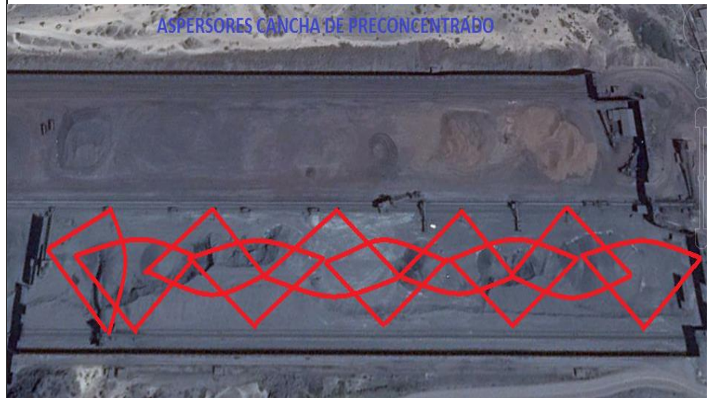
Ilustración N°6: Distribución del regadío en la cancha de Preconcentrado.
