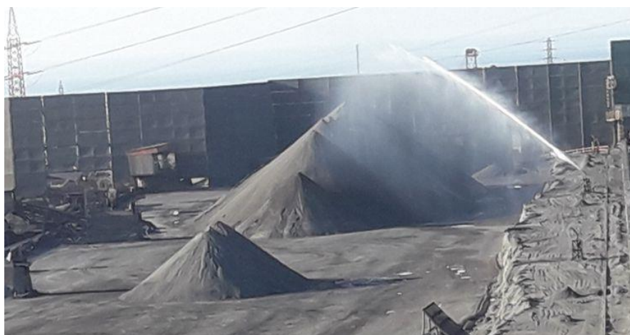
Ilustración N°5: Aspersores en funcionamiento, Cancha principal de acopio – Planta de Pellets
